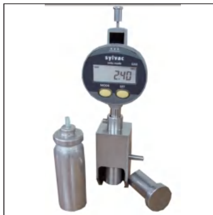
借助工装测量内孔
