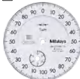
分度值: 0.001mm, 测量范围: 5mm 宝石轴承型
